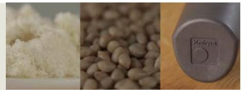
Trifilon Switch® (トリフィロン スイッチ) は、自然の麻から作られた、工業的に 100%堆肥化可能なバイオ複合材料です。従来のプラスチックよりも水や裂けに強く、丈夫で長持ちする素材です。
